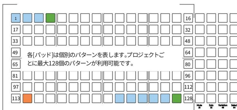
現在アクティブなパターンは点灯オレンジ、その他の利用可能なパターンは点灯青です。暗く点灯緑のパッドは、空のパターンを示します。点滅しているパッドは、再生待ちのパターンを示します。
